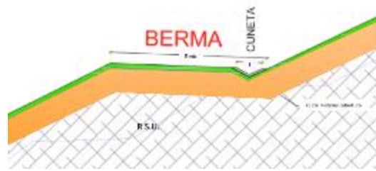
Ilustración 53. : Drenaje sección camino Tipo V
